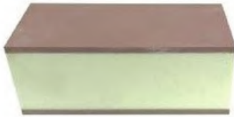
12205 - BLOQUE PARA PRUEBAS BIOMECÁNICAS 10 PCF CON BICORTICAL 3MM - 9,5 X 4,5 X 3,6 CM
