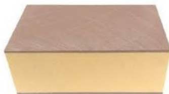
12207 - BLOQUE PARA PRUEBAS BIOMECÁNICAS 20 PCF CON BICORTICAL 2MM - 9,5 X 4,5 X 3,4 CM
