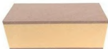
12214 - BLOQUE PARA PRUEBAS BIOMECÁNICAS 30 PCF CON BICORTICAL 3MM - 9,5 X 4,5 X 3,6 CM
